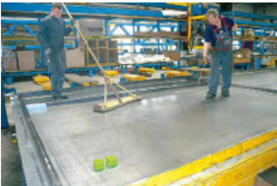
Abb. 4.1. Auftragen des Trennmittels
