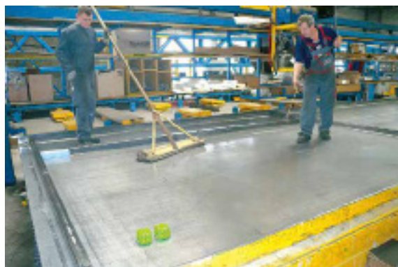
Rys. 4.1. Nakładanie środka antyadhezyjnego
