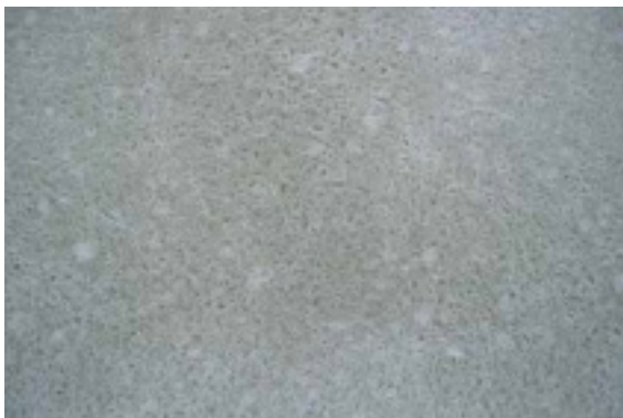
Rys. 5.2 Grube kruszywo odciska się na powierzchni
