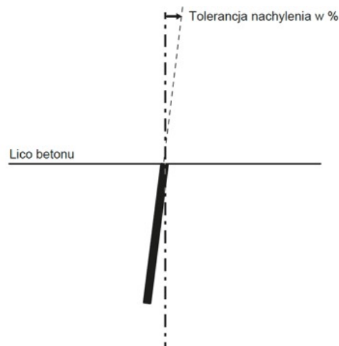
Rys. 5.4 Mocowanie śrubowe z tolerancją maksymalnego nachylenia.
